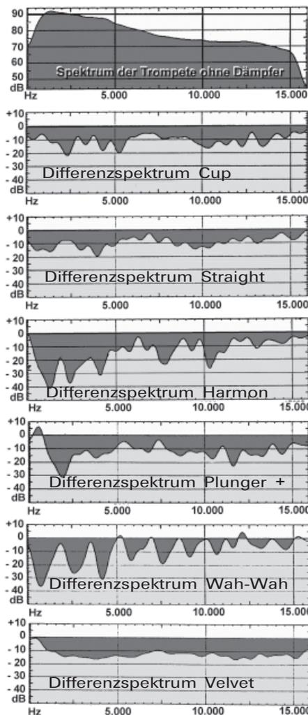
**Straight:** Durch die kleine Austrittsöffnung werden weniger tiefe Frequenzen abgestrahlt. Um 1800-2400 Hz ist die Differenz geringer. Ein starker Antiformant liegt bei 3950 Hz.
