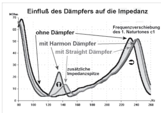
Der Vergleich von Impedanzkurven, mit und ohne Dämpfer gemessen, zeigt, daß fast alle Dämpfer zusätzliche Spitzen hervorrufen. Die obige Abbildung demonstriert diese Wirkung.
