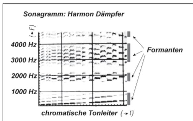
Das Sonagramm in der linken Abbildung zeigt die unterschiedlich starken Teiltöne beim Spiel einer chromatischen Tonleiter mit einem Harmon-Dämpfer. Frequenzbereiche, die unabhängig von der gespielten Tonhöhe starke Teiltöne aufweisen, werden Formanten genannt.
